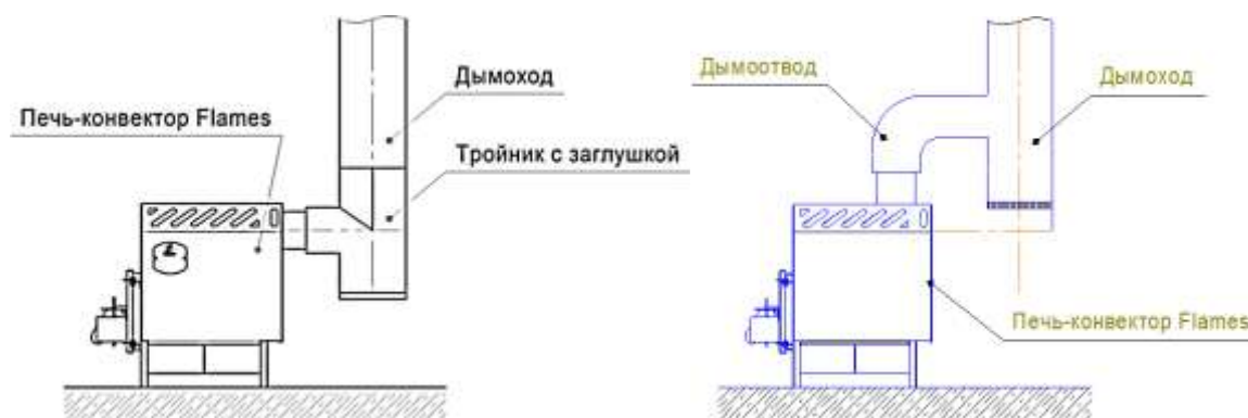
Рис.7 - Варианты присоединения печи к дымоходу
